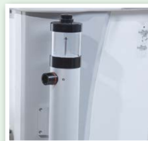
Приемный узел системы активного выведения отработанной газовой смеси
