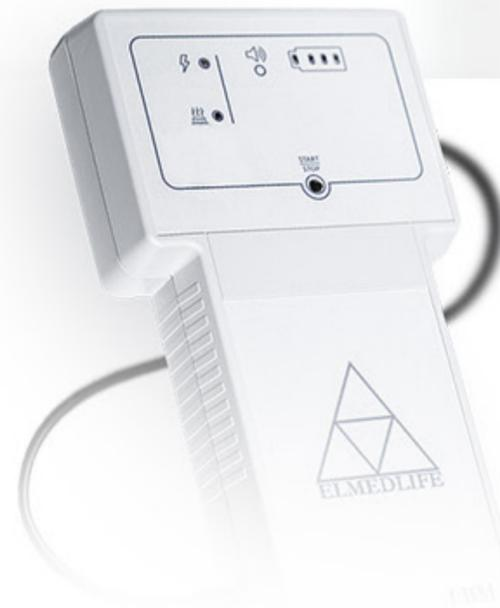
Управление каждым аппаратом производится **блоком управления**, соединённым кабелем с гарнитурой. В блоке управления **содержится** электронная схема, управляемая встроенным программным обеспечением и аккумуляторная батарея.
