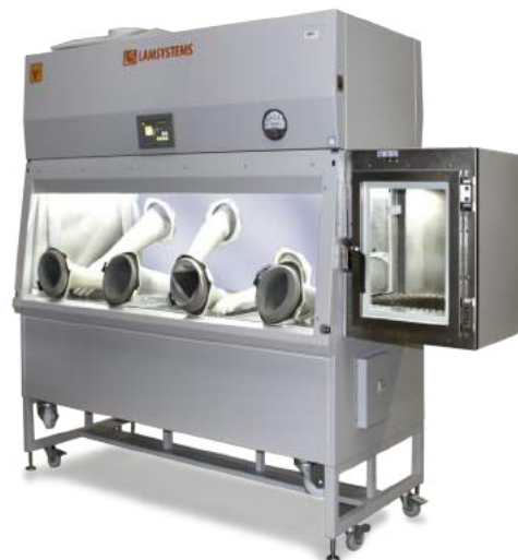
Бокс VIS-A-VIS с разноуровневым расположением перчаточных портов
