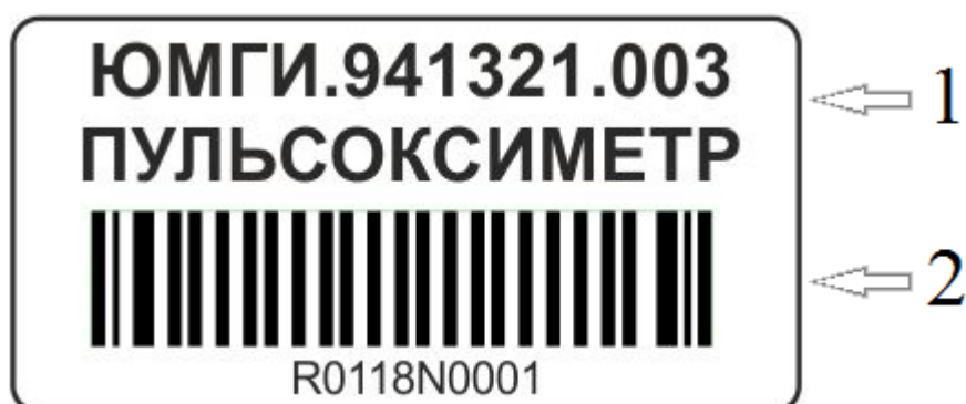
Рисунок 1.3 – Этикетка пульсоксиметра ЮМГИ.941321.003
