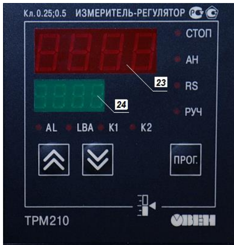
Рис.3. Лицевая панель измерителя-регулятора TPM210.
